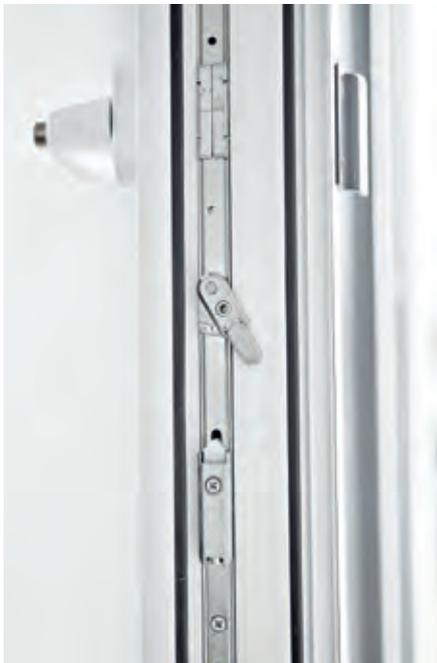
*Für einen erhöhten Einbruchschutz, werden Fenster und Balkontüren, die vom EG aus zugänglich sind, mit umlaufenden Pilzkopfverriegelungen und abschließbaren Fenstergriffen ausgestattet.*
