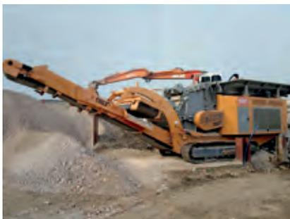
Mit unseren mobilen Brecheranlagen, sowie einer mobilen Bauschuttsortieranlage können vor Ort hochwertige wieder verwertbare Recyclingbaustoffe gewonnen werden.
